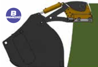
Caricamento nella parte superiore del silo. Deflettore brevettato in posizione bassa
